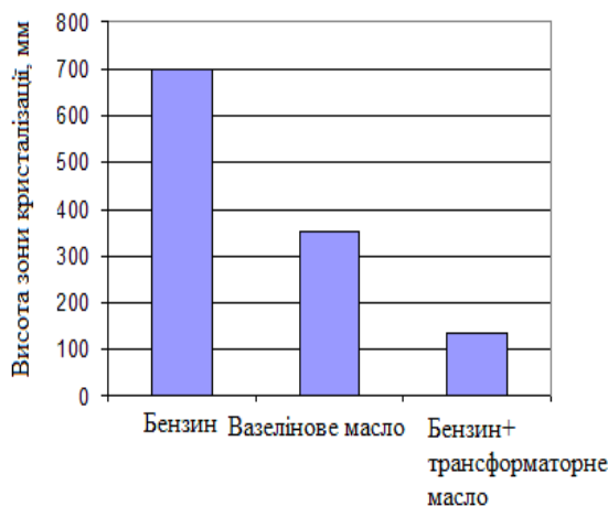
Рис. 4 – Залежність висоти зони кристалізації від інертного середовища
